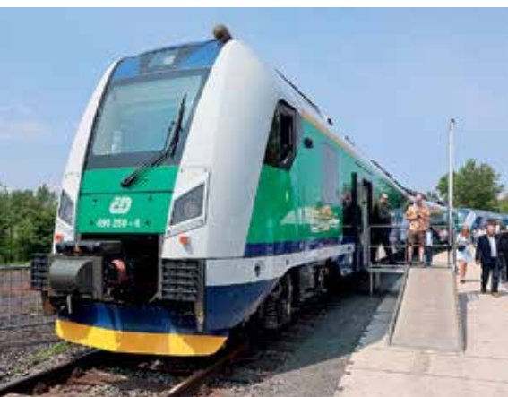
Dvouvozový RegioPanter vybavený trakčními bateriemi pro jízdu mimo trolejové vedení prezentovaly České dráhy v loňském roce jako čerstvou novinku. Nyní už jeden ze čtyř strojů řady 690 představoval jejich spolehlivý běžný provoz v regionu a naznačoval další možnosti rozšíření bezemisních vozidel.
