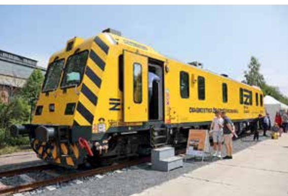
Správa železnic tradičně přivezla hned několik strojů určených k údržbě infrastruktury. Například EM100 pro diagnostiku železničního svršku zejména u regionálních tratí. Zvládá měřit geometrické parametry koleje či snímkovat a kontrolovat příčný profil kolejnic.
